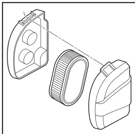
Чистка воздушного фильтра. Ослабьте винт, снимите крышку и снимите картридж фильтра. В случае засорения воздушного фильтра двигатель будет работать ненадлежащим образом и может выйти из строя. Заменяйте воздушный фильтр ежегодно или даже чаще, если вы работаете в условиях сильной запыленности. Обращайтесь к руководству по эксплуатации двигателя. (Прочитайте также прилагаемое руководство по эксплуатации двигателя.)
